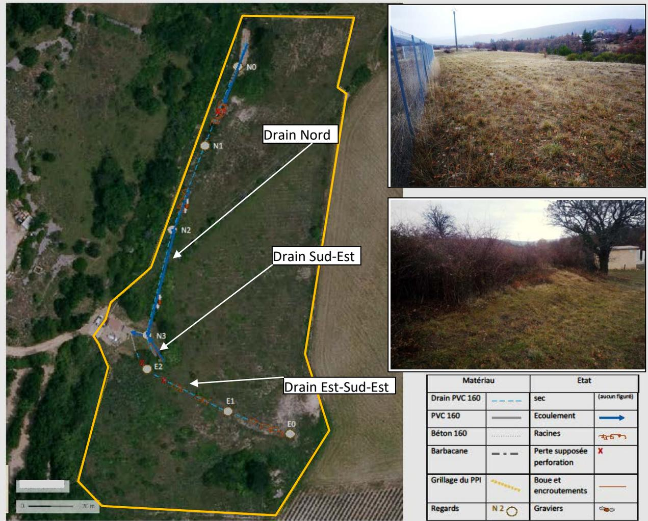
Figure n°3 : Localisation des drains et regards, état du système de captage le 09/10/2017 (document CIMEO)
